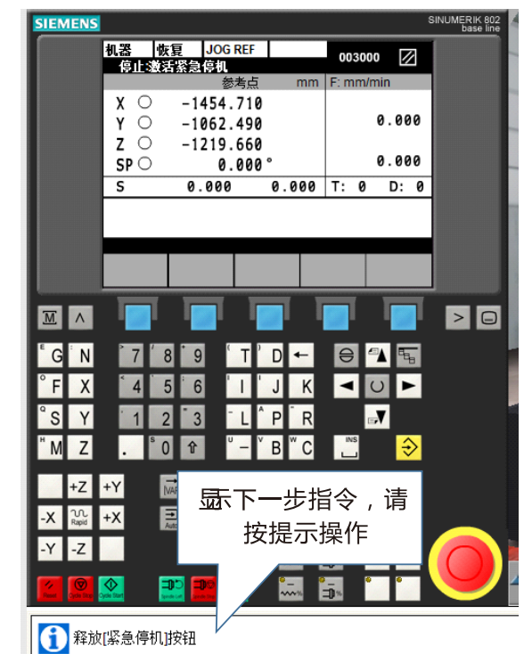
图2.18 机床电源接通
