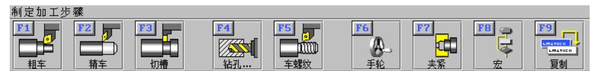
图5.14 数控车床新建刀路功能
